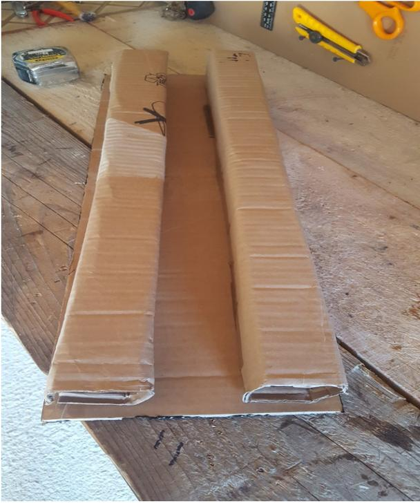
Nous avons assemblé les poutres au tablier à l'aide d'un scotch double face .
